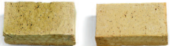
Kohlegebrannter Mauerstein von Petersen Tegl. Der Stein zeichnet sich durch einen optimalen Porenaufbau aus. Frostspaltungen können nicht entstehen. Gebrochener Stein/geschnittener Stein.
